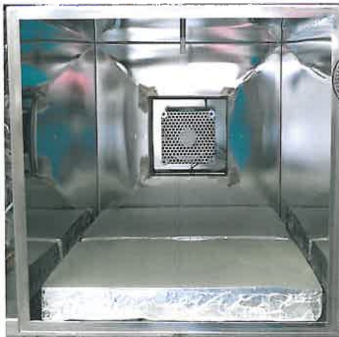
Bild 3: Prüfkörper in der 200 L-Emissionsprüfkammer
