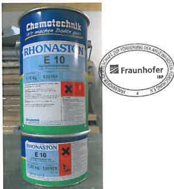
Bild 1: Epoxidharzversiegelung „Rhonaston E10“
